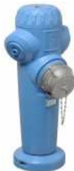
Poteaux d'aspiration de 100 mm à réseau sec, munis d'une seule sortie de 100 mm. Pas de volant ni de carré de manœuvre.
